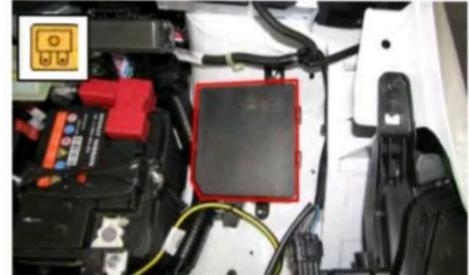
2. Dargestellte Sicherung im Kastendeckel entfernen.
